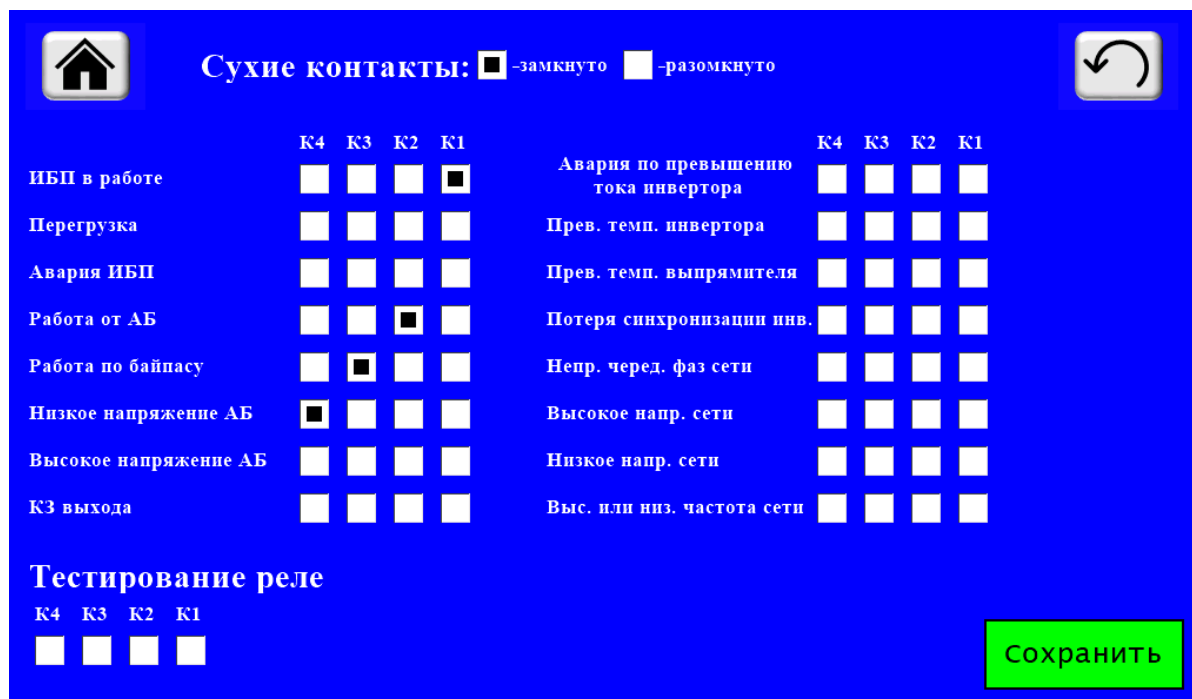
Рисунок 17 – Страница пульта управления с настройками «сухих» контактов
