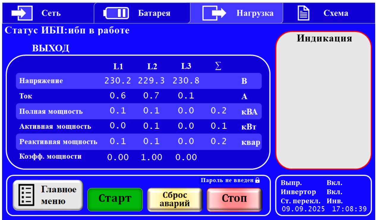
Рисунок 5 – Страница пульта управления вкладки «Нагрузка»
