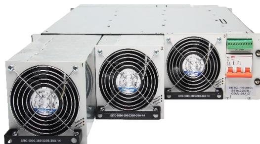
ИПС имеет принудительный тип воздушного охлаждения. Вентилятор охлаждения встроен непосредственно в силовой модуль-выпрямитель. Вентилятор управляется сигналом с контроллера УКУ, за счет чего обеспечивается мониторинг ресурса работы вентилятора (наработка в часах). Забор охлаждающего воздуха организован с лицевой стороны, выброс нагретого – с задней стороны.
