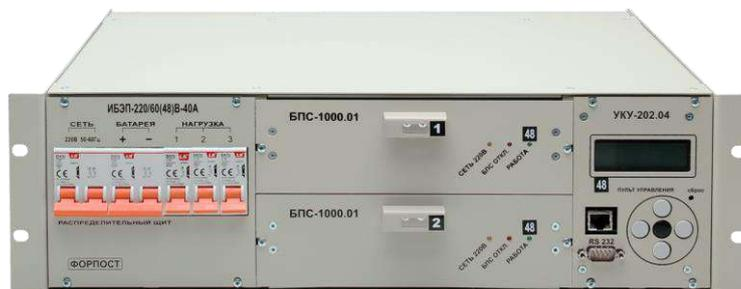
ИБЭП должен эксплуатироваться в закрытых отапливаемых и вентилируемых помещениях. ИБЭП состоит из корпуса с кросс-платой, клеммным блоком и панелью АВ, и устанавливаемых в корпус одного или двух БПС, в зависимости от типа исполнения, и УКУ.
