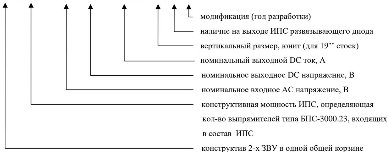
При работе 2-х ЗВУ на общую АКБ и нагрузку обязательным условием является наличие на выходе у каждого ИПС развязывающего диода.
