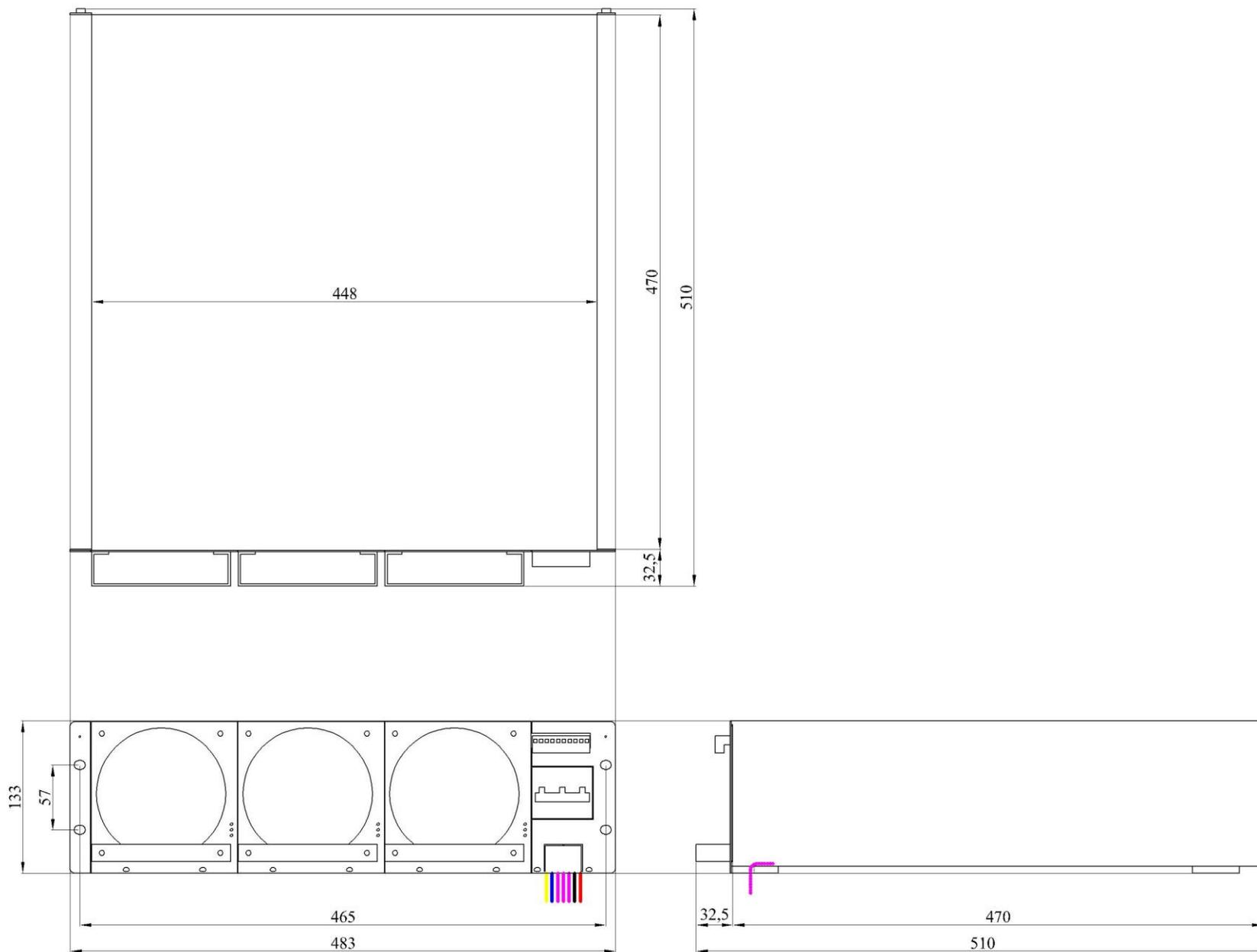
**СОСТАВ КОРЗИНЫ ИПС-9000-380/220В-45А-0/3-3U-(D)-23 В СООТВЕТСТВИИ С ЧИСЛОМ УСТАНОВЛЕННЫХ МОДУЛЕЙ**
