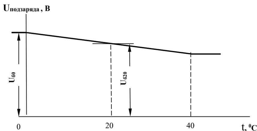
Напряжение на выходе ИПС линейно изменяется при изменении температуры датчика  $t_1$  от 0 до 40°C. В установках задаются напряжение на выходе ИПС при 0°C-  $U_{60}$  и при 20°C-  $U_{620}$ .
