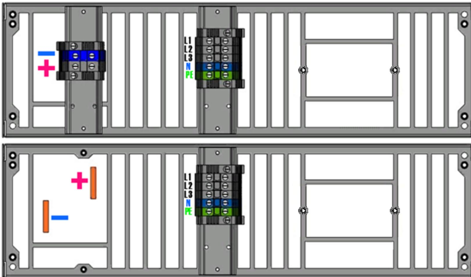
**ОБЩИЙ ВИД ИПС-F В КОНСТРУКТИВНОМ ИСПОЛНЕНИИ 19" 3U СО ВХОДОМ АС 220В**
