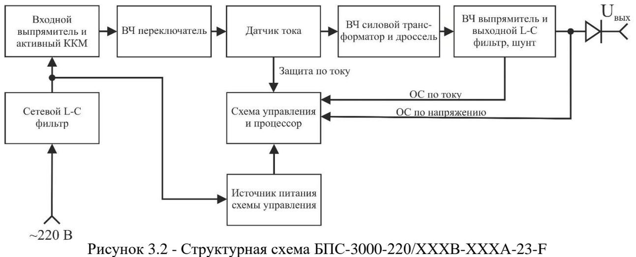
Рисунок 3.2 - Структурная схема БПС-3000-220/XXXВ-XXXXА-23-F
