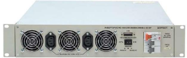
Инверторы могут работать одиночно или параллельно как без внешнего байпаса, так и с внешним статическим электронным байпасом соответствующей мощности. Допускается включение на параллельную работу до 15-ти инверторов, однако предприятие-изготовитель рекомендует ограничиться тремя инверторами в этом конструктивном исполнении. Инвертор имеет следующие защиты:
