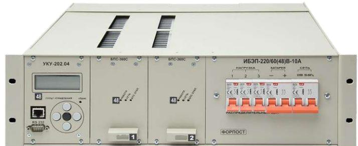
ИБЭП должен эксплуатироваться в закрытых отапливаемых и вентилируемых помещениях. ИБЭП состоит из корпуса, одного или двух БПС, кросс-платы, устройства контроля и управления (УКУ) с контроллером, узла коммутации.
