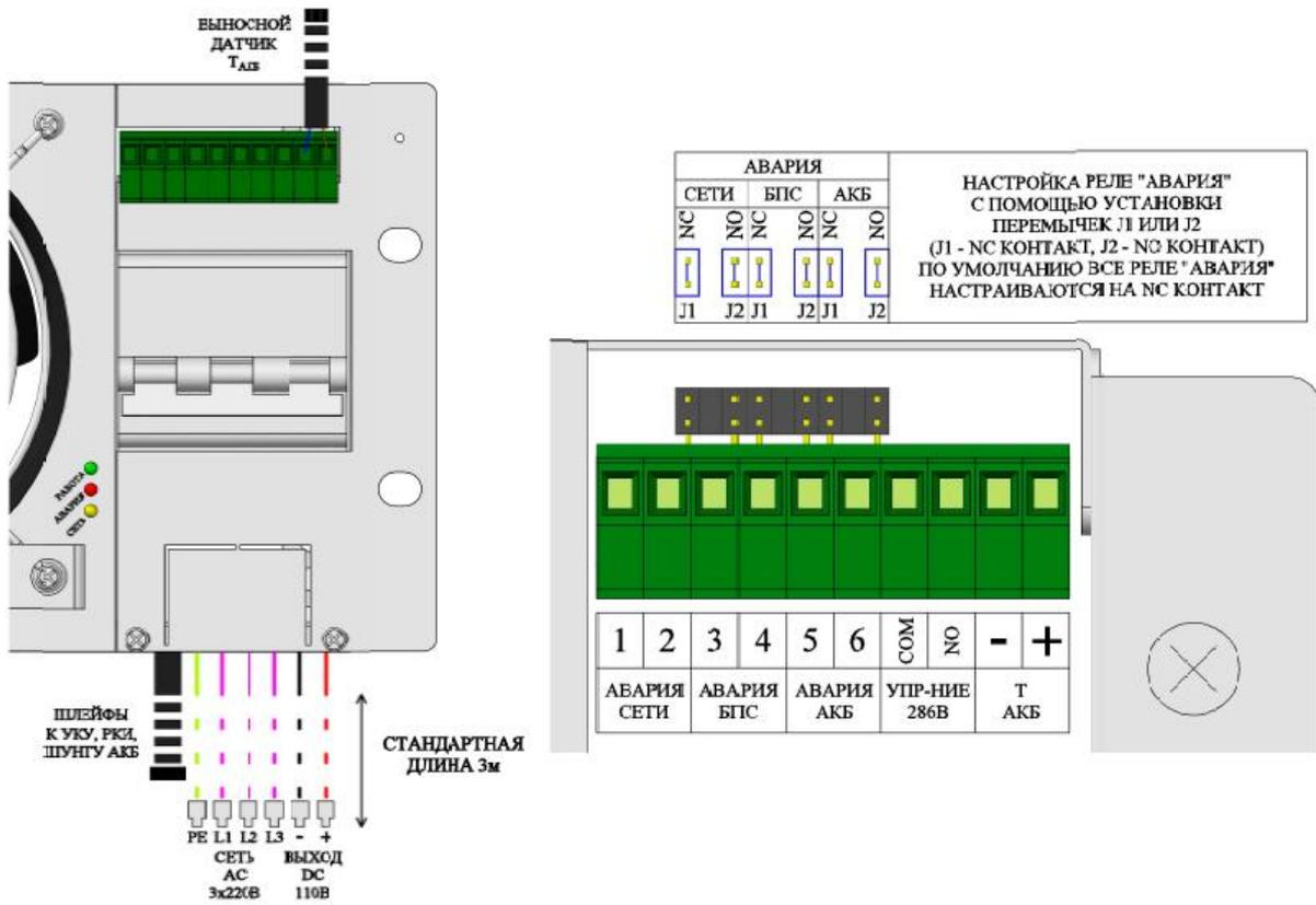
Рисунок 4. Распиновка силовых и сигнальных кабелей корзины ИПС-9000-3x220/110В-90А-0/3-3U-(D).
